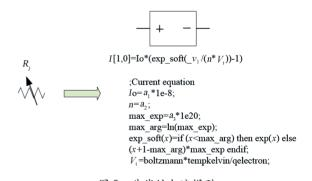
图 5 非线性电流模型 Fig. 5 Nonlinear current model
