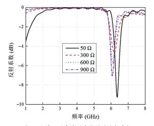
图 7 加载不同负载时滤波器的反射系数 Fig. 7 Reflection coefficient of the filter with different loads
