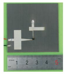
图1 根据软件自带模型设计的整流电路的实
