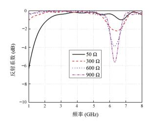
图 2 加载不同负载时滤波器的反射系数 Fig. 2 Reflection coefficient of the filter with different loads
