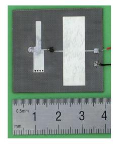
图 6 重新设计的整流电路的实物图 Fig. 6 Prototype of the redesigned rectifying circuit
