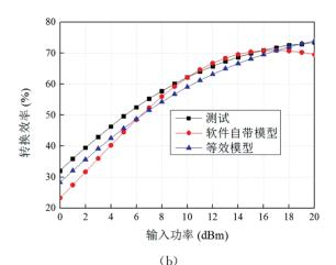
图 8 重新设计的整流电路的转换效率
