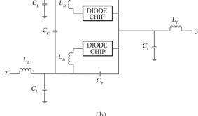
图 4 HSMS-282C 二极管的线性模型 (a) 管芯的线性模型;(b) SOT-323 的封装模型
