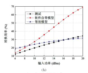
图 3 整流电路转换效率 (a)转换效率随负载的变化;(b)转换效率随输入功率的 变化
