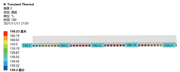
图 3 热封刀贴合面表面温度
