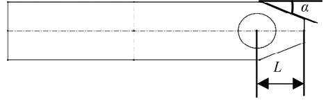
图 6 热封刀尺寸变量
