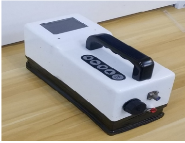
图 2 便携式 \alpha - \beta - \gamma 谱仪 Fig. 2 Portable \alpha - \beta - \gamma spectrometer
