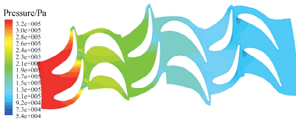
图 15 膨胀比为 3, 转速为 1.2n_0 时透平内压力云图
