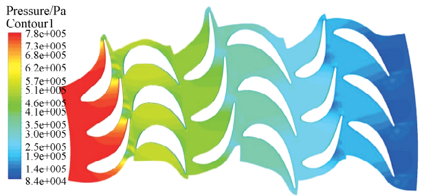
图 7 50% 叶高处压力分布云图 Fig. 7 The pressure distribution at 50% span
