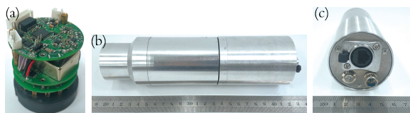
图 8 电路结构: (a) 板-板堆叠实物图, (b) \gamma 能谱仪, (c) 交互式接口
