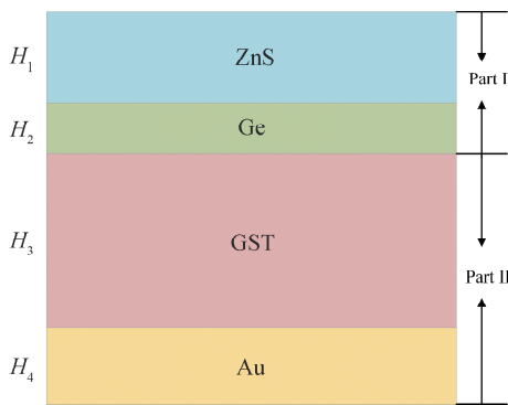
图 1 吸波器的示意图, 每层的厚度从顶部到底部分别记为 H_1, H_2, H_3 和 H_4
