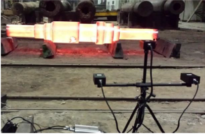
(b) 结构光三目视觉测量
